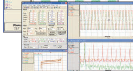
SCOPEin@BOX, gleichzeitige Anzeige von "X(t)", "XY" und "FFT"
